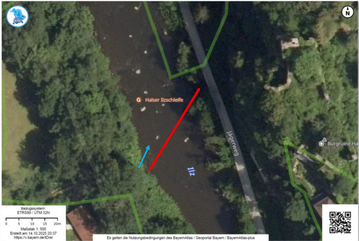
Abb. 7: Verlauf des Störsteinfeldes in der RWS Hals (rote Linie). Blauer Pfeil: Auslauf FAA
