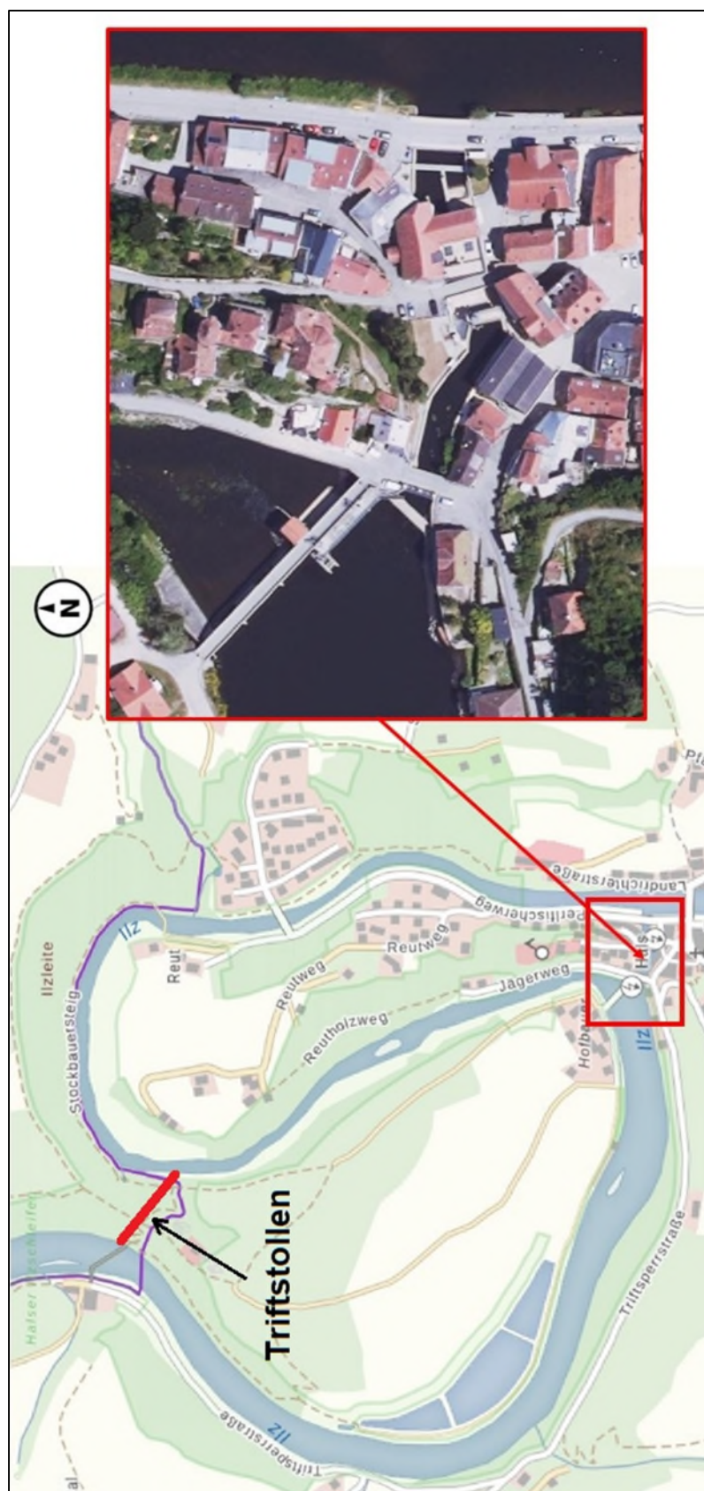
Abbildung 2: Flussschleife mit 180° Richtungsänderung, Lage des Triftstollens; Luftbild des WKW Hals (Quelle: BayernAtlas)
