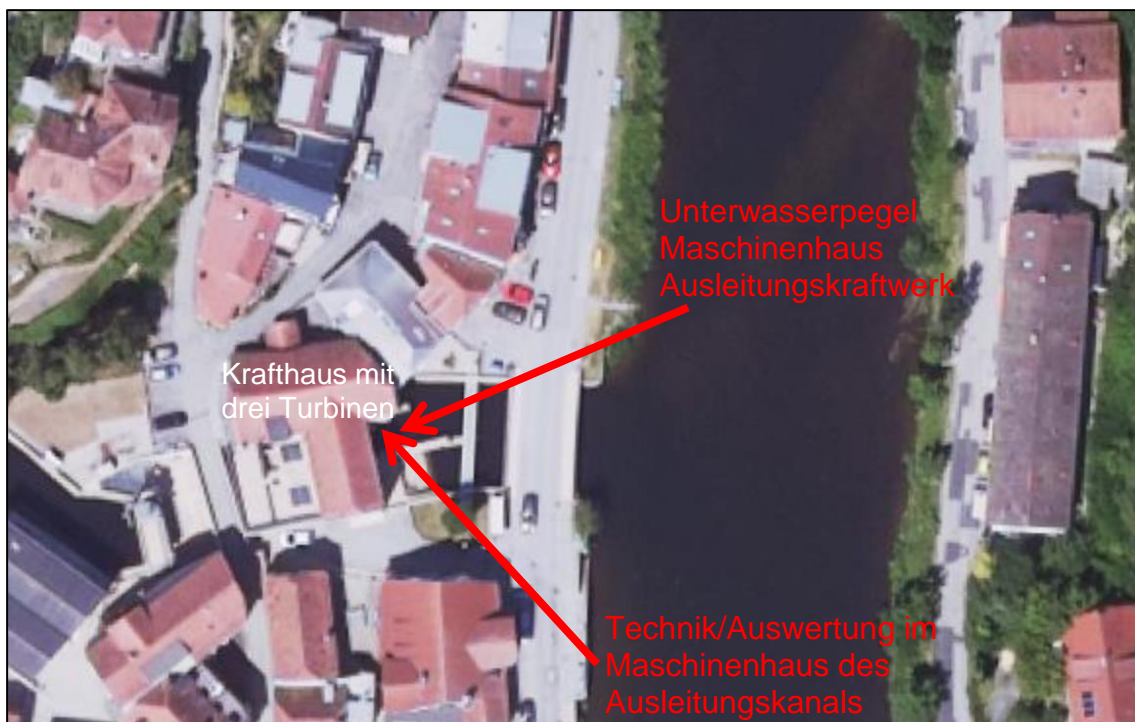
Abbildung 2: Pegelmessung am Maschinenhaus des Ausleitungskraftwerks Hals
